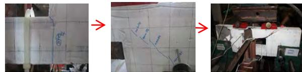
Gambar 2. Pola Keruntuhan Balok Kastella Komposit Mortar
