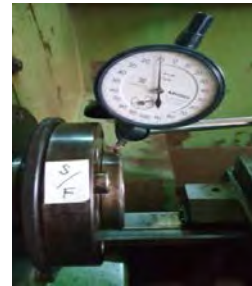
Gambar 14: Posisi Dial Indikator Untuk Pengukuran Kosentrisitas Spindel
