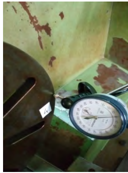
Gambar 17 : Posisi Dial Indikator Untuk Pengukuran Ketegaklurusan Sumbu Terhadap Eretan Lintang
