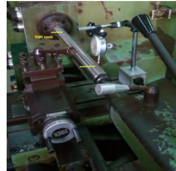
Gambar 16 : Posisi Dial Indikator Untuk Pengukuran Kesejajaran Sumbu Terhadap Bed
