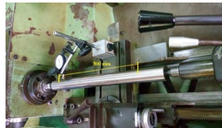
Gambar 15 : Posisi Dial Indikator Untuk Pengukuran Kelurusan Spindel
