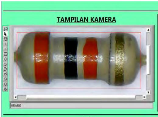
Gambar 3. Program image processing Client program merupakan program yang terdapat pada komputer *client* yang berfungsi untuk menerima data yang dikirim server yaitu berupa jenis data *string* yang berisi informasi warna gelang resistor yang ditangkap kamera *server*. Pada akhir program terdapat tambahan error dialog untuk menghentikan atau melanjutkan program apabila error terjadi.
