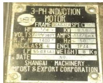
Gambar 3. Plat nama motor DOL Berdasarkan dari Gambar 3. pelat nama motor, motor yang digunakan dihubungkan dalam hubungan bintang
