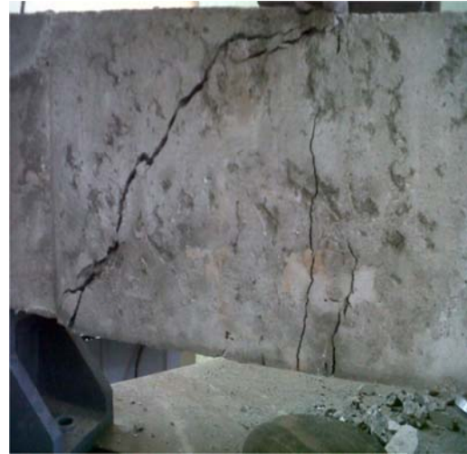
Gambar.5.6 Keruntuhan B.Uji Precast 1
