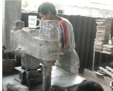
Gambar 3.11. Foto Proses Penekanan Paving Betik dengan Mesin Pres
