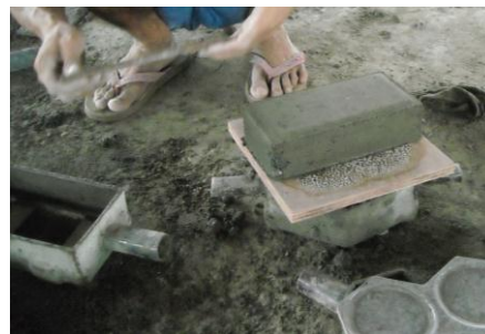
Gambar 3.6: Foto paving blok setelah dikeluarkan dari cetakan
