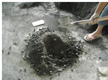
Gambar 3.1: Foto Proses pencampuran bahan paving blok.
