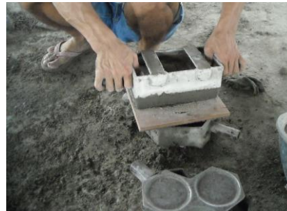
Gambar 3.5: Foto Proses pembukaan cetakan paving blok.
