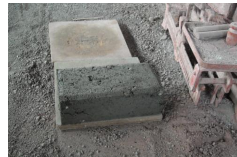
Gambar 3.12: Foto Permukaan Paving Blok Betik retak-retak
