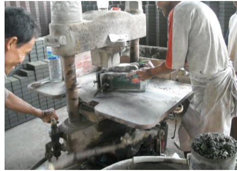
Gambar 3.10. FotoAdukan untuk Paving Betik dimasukan kedalam cetakan
