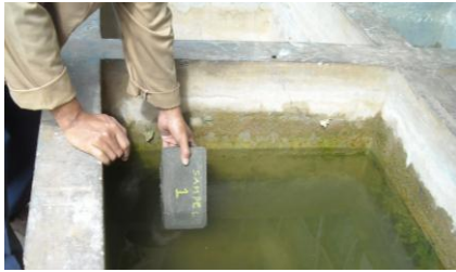
Gambar 3.8: Foto proses perendaman benda uji paving blok.
