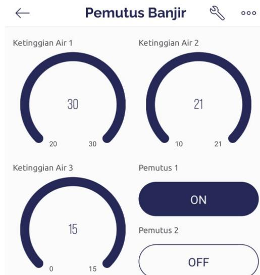
Gambar 5 Tampilan *Monitoring* pada aplikasi Blynk di *smartphone*
