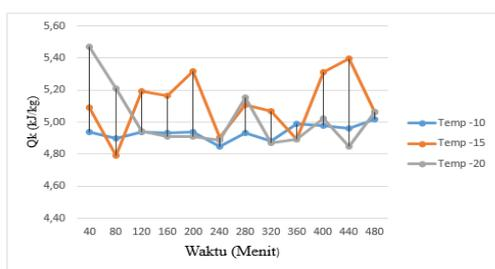
Gambar 6. Perubahan Temperatur Kabin Terhadap Besar Kalor yang Dilepaskan Kondensor
