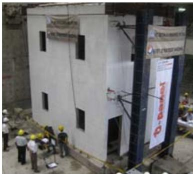
Foto 3. Pengujian bangunan 2 lantai
