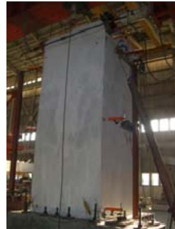
Foto 2. Pengujian sambungan antar dinding b-panel
