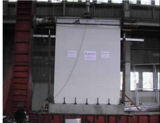
Foto 1. Pengujian dinding b-panel
