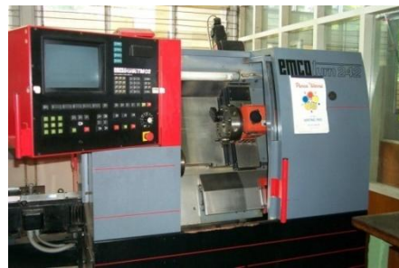
Gambar. 2 Mesin Bubut CNC 2 sumbu EMCO ET242
