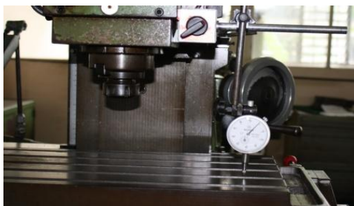
Gambar 5. Pengukuran kedataran permukaan meja kerja
