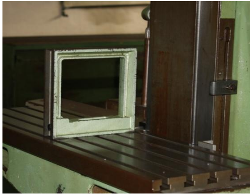
Gambar 1b. Pengukuran Penyelarasan Meja Kerja Arah melintang
