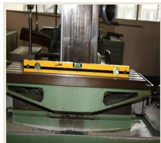
Gambar 1a. Pengukuran Penyetaraan Meja Kerja Arah Memanjang
