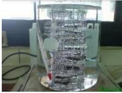
Gambar 7. Perebusan Sampel Uji Porositas
