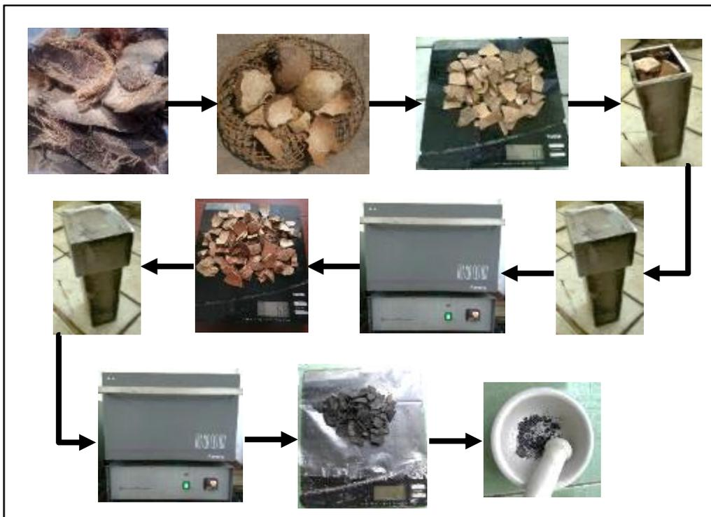
Gambar 4. Pembuatan karbon tempurung kelapa
