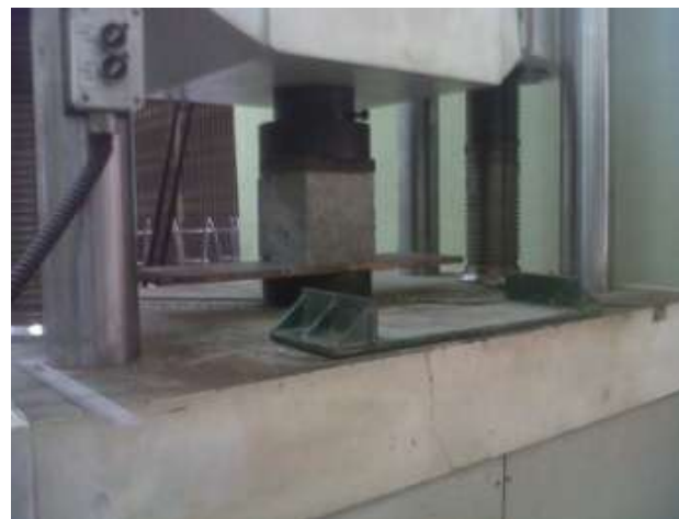
Gambar 1. Uji Kuat Tekan Kubus Beton
