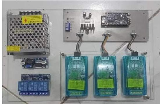
Gambar 12. Sistem Monitoring dan Kontrol 3 Fasa
