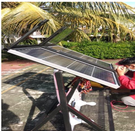
Gambar 3. Pengujian pengaturan posisi reflektor untuk memperoleh daya luaran optimum
