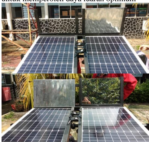
Gambar 4. Pengujian panel surya tanpa reflektor dan dengan berbagai jenis reflektor
