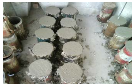
Gambar 6 Benda Uji Beton Silinder yang akan dilubangi
