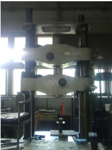
Gambar 12 Setup Mesin dan Benda Uji Pengujian Bond Pull Out
