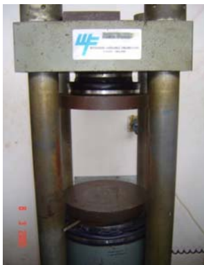
Gambar 12 Setup Pengujian Kuat Tekan Beton
