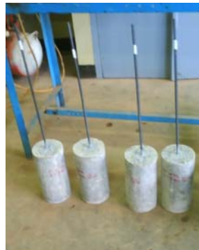
Gambar 10. Silinder Beton yang Ditanam Tulangan dengan Dilapisi Sikadur ® 31 CF Normal
