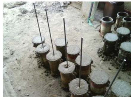
Gambar 7 Benda Uji Beton Silinder yang Dicor secara Monolit
