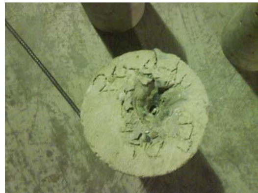
Gambar 17 Permukaan Lubang Hancur setelah Pengujian Bond Pull Out Dilakukan
