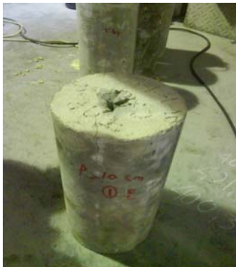
Gambar 15 Retakan yang terjadi pada beton monolit dengan penanaman tulangan 100 mm
