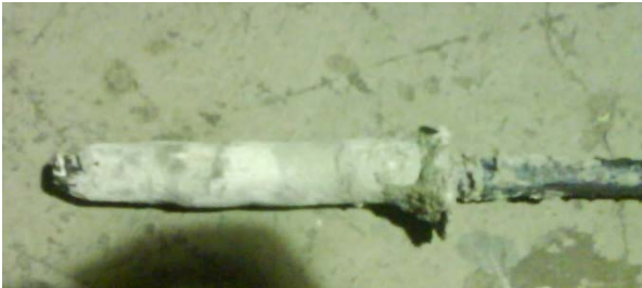
Gambar 11 Epoxy masih Menempel Ketika Baja Tulangan sudah Terlepas dari Beton Silinder
