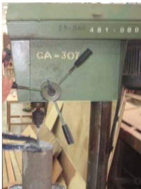
Gambar 8 Proses Pengeboran Benda Uji dengan Menggunakan Mesin Bor Tipe Table
