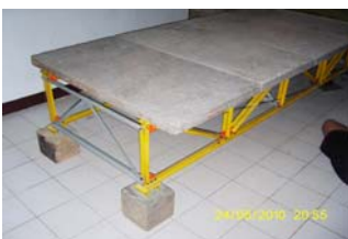
Gambar 7. Prototype Jembatan Alat Uji Pembebanan
