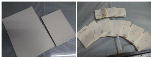
Gambar 2. Contoh dummy, sebelah kiri 1 lembar plano dan sebelah kanan contoh dummy dalam beberapa katern untuk 1 buku jadi)
