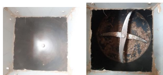
Gambar 26. Pisau Pencacah Memutar (a); Pisau Pencacah Diam (b)
