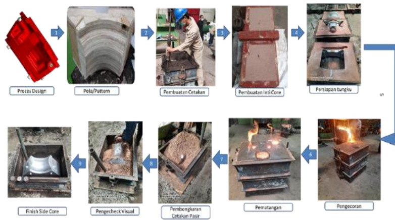
Gambar 4. Tahapan proses pembuatan cetakan side core
