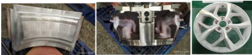
Gambar 11. Side die SKD6 dan produk Visual tidak ada retak rambut
