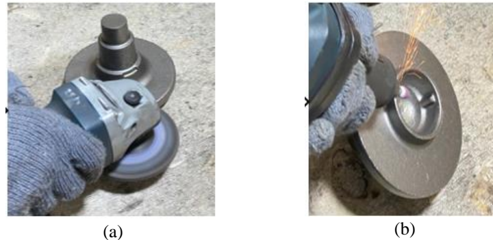
Gambar 1. Proses 1 finishing bagian permukaan bawah sebelum perbaikan diberikan pada gambar (a). Gambar (b) menunjukkan proses 4 finishing bagian lubang tengah sisi atas setelah perbaikan
