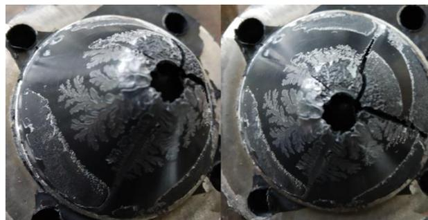
Gambar 4 Campuran Komposit pada Ruang Extruder Head
