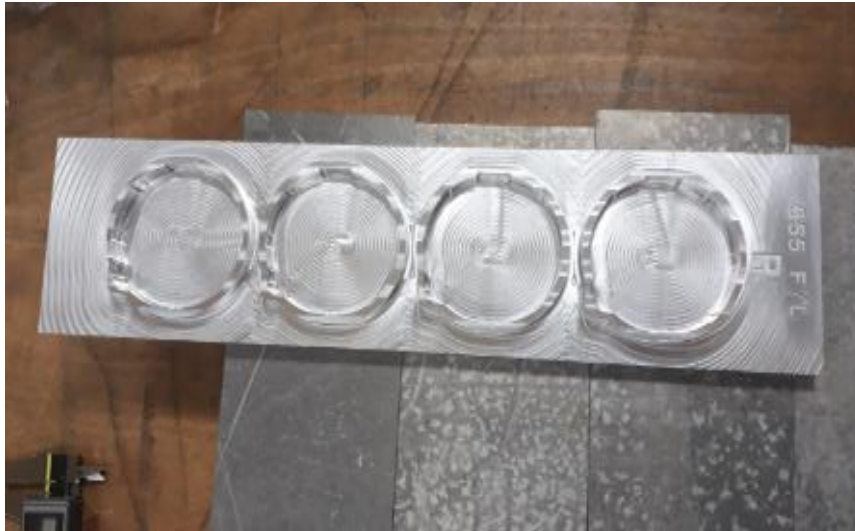
Gambar 5. Keberhasilan hasil pembuatan jig
