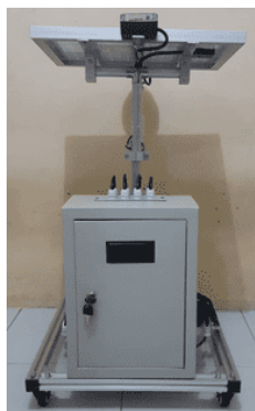
Gambar 2. Realisasi Alat Solar Tracker
