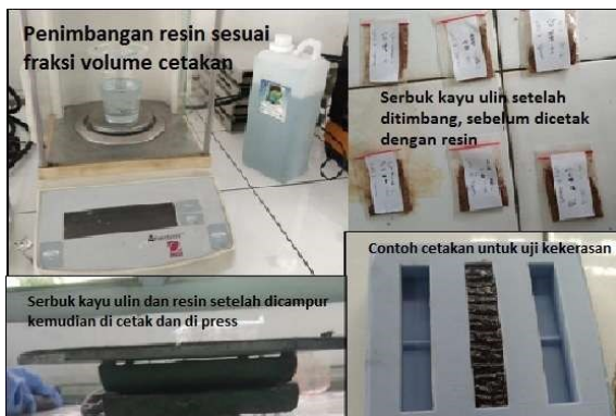
Gambar 12. Proses pembuatan komposit
