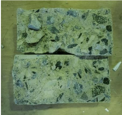
Gambar 6. Perbandingan Kuat Tarik Belah antara Beton Menggunakan Campuran Cangkang Telur dan Beton Tidak menggunakan Cangkang Telur
