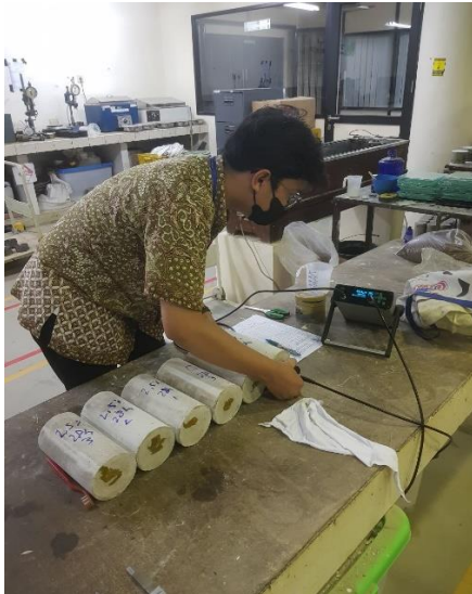
Gambar 8. Pengujian Kuat Tekan Crushing Test Dan Kecepatan Rambat Gelombang Ultrasonik UPV Test
