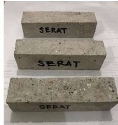
Gambar 3. Spesimen Benda Uji Kuat Lentur Substitusi Serat Fiber
