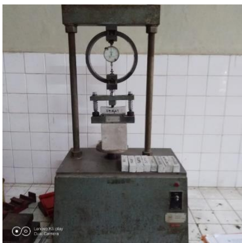
Gambar 2. Perletakan Benda Uji dan Pembebanannya
