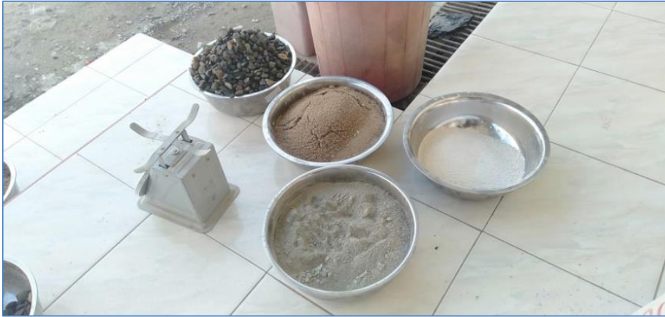
Gambar 1. Bahan pembuatan benda uji beton
