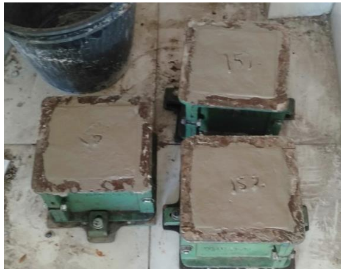
Gambar 5. Beton dalam cetakan.
