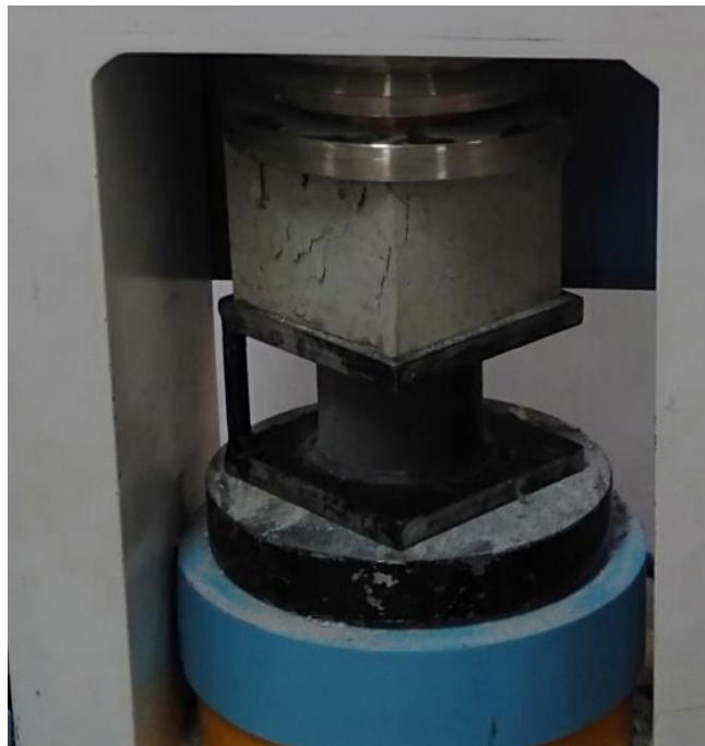
Gambar 8. Pengujian kuat tekan beton.
