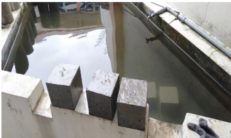
Gambar 6. Beton setelah diangkat dari bak air.
