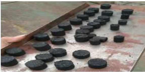
Gambar 13. Proses pengeringan briket
