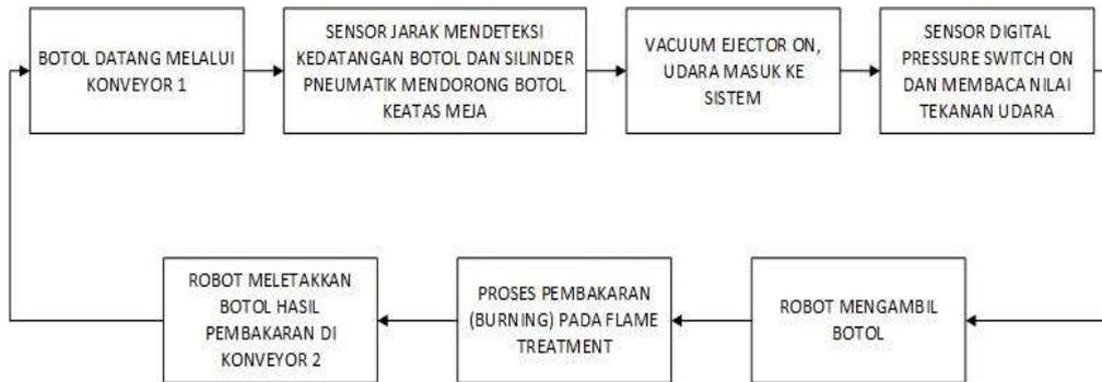
Gambar 4. Diagram blok cara kerja sistem
