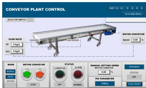
Gambar 3 Tampilan Utama HMI
