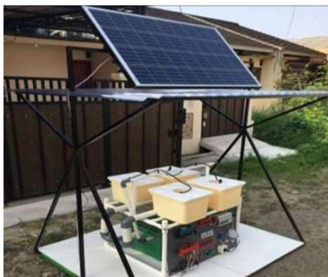
Gambar 3. Pengujian Alat Hydroponic Drip System
