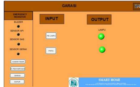
Gambar 9. Tampilan pada SCADA berupa status menyala pada lampu Garasi.
