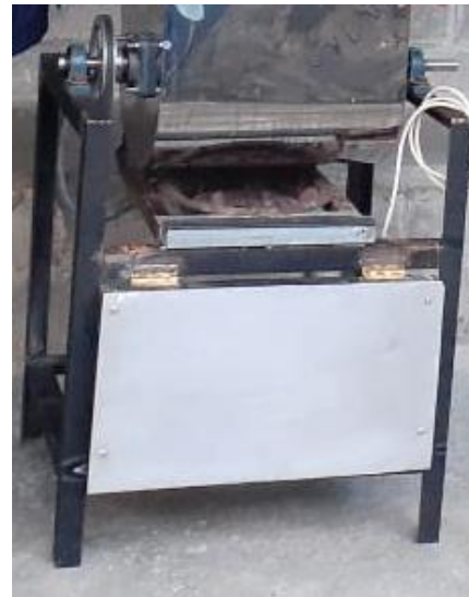
Gambar 4. Mesin pengaduk isi adonan bakpia
