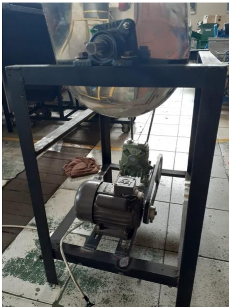
Gambar 3. Proses fabrikasi mesin pengaduk isi adonan bakpia
