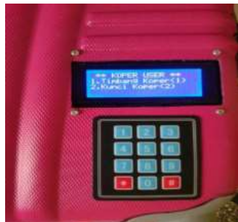
Gambar 6. Realisasi Sistem Penimbang
